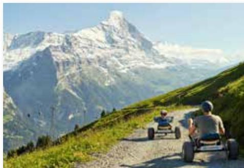
aus Gokart und Schlitten. Sie kommt auf fast jedem Terrain den Berg runter und ist dabei sicher, bequem und auch für Kinder ab 135 Zentimeter Grösse geeignet. Der Schwerpunkt liegt tief, die Räder stehen weit auseinander, und hydraulische Bremsen sorgen dafür, dass man das Tempo über lange Strecken im Griff hat. So auch auf der drei Kilometer langen Naturstrasse von Schreckfeld nach Bort: Schlittelspass auf Rädern, den ganzen Sommer lang.
